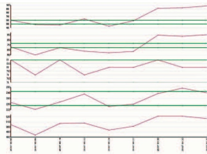
Fig. 3 Display das cinco medições de uma produção com grande flutuação de qualidade (cada uma das linhas vermelhas representa os 9 pontos de medição conectados) sobre um eixo de tempo com tolerâncias (linhas verdes). De cima para baixo no display: 1. Adensamento do concreto arquitetônico, 2. Adensamento do concreto vazado, 3. Altura do produto, 4. Densidade do produto, 5. Peso (sem linhas tolerância)
