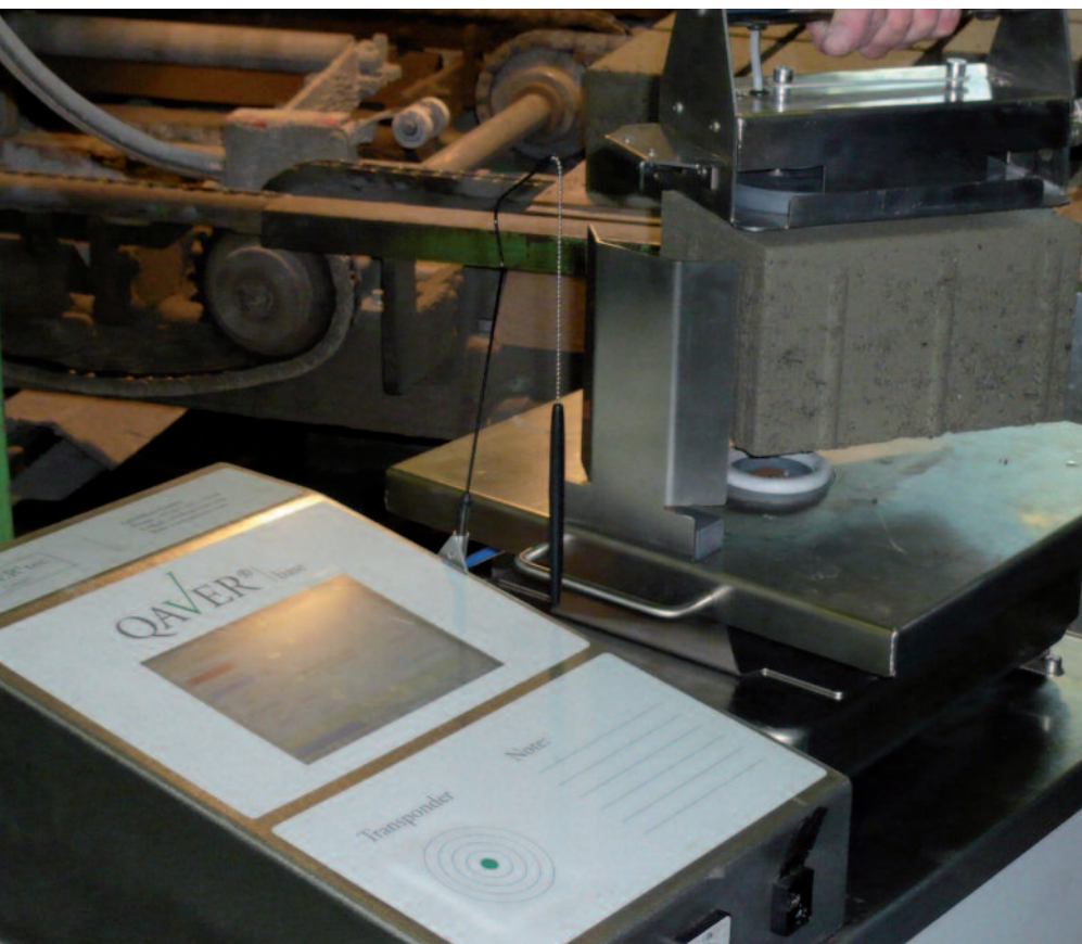
Fig. 1 A Qaver é posicionada diretamente na planta e só precisa de 220 V para sua operação. O dispositivo de içamento permite que os pavers sejam içados até 140mm ou pesarem até 12kg. Vários tipos de ventosas estão disponíveis dependendo da superfície do produto
