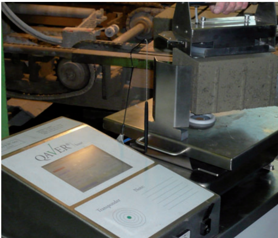
Abb. 1: Der Qaver wird direkt an der Anlage platziert und benötigt für den Betrieb nur die Bereitstellung von einem 220-V-Anschluss. Die Hebevorrichtung ermöglicht ein Anheben von Pflastersteinen bis zu einer Höhe von 140 mm oder einem Gewicht bis zu 12 kg. Verschiedene Saugertypen stehen für unterschiedliche Oberflächenbeschaffenheiten zur Verfügung.
