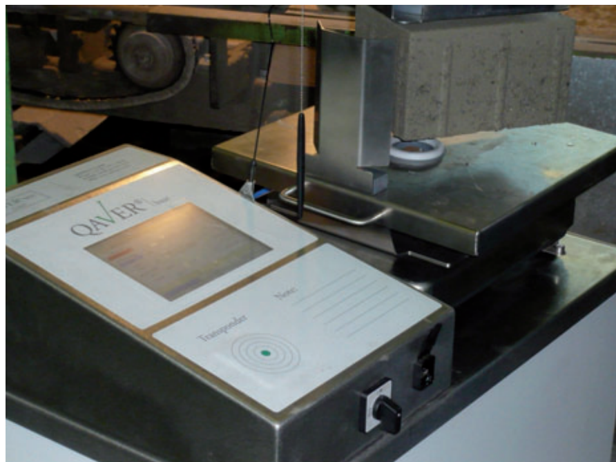
Fig. 1. El Qaver se ubica directamente en la instalación y tan sólo requiere para su funcionamiento disponer de una conexión de 220V. El dispositivo de elevación permite levantar adoquines de una altura de hasta 140 mm o un peso de hasta 12 kg. Hay disponibles diferentes tipos de aspirador para las diversas acabados de las superficies.
