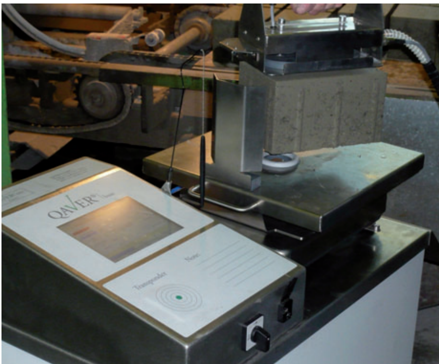
Fig. 1 Le Qaver est mis en place directement sur l'installation et ne nécessite pour son fonctionnement qu'un raccordement 220 V. Le dispositif de levage permet de lever des pavés d'une hauteur maximum de 140 mm ou d'un poids maximum de 12 kg. Différents types d'aspirateurs sont proposés pour les différentes qualités de surface.
