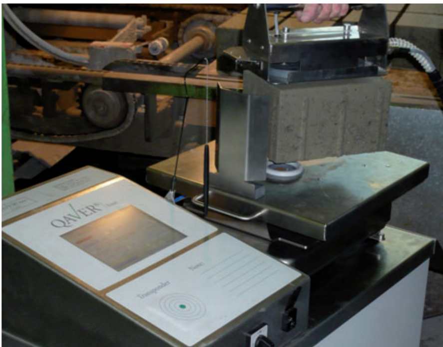
Fig. 1: Lo strumento Qaver viene posizionato direttamente sull'impianto e per il funzionamento occorre soltanto la predisposizione di una presa 220V. Il dispositivo di sollevamento consente il sollevamento di masselli fino a 140 mm di altezza o un peso che arriva fino a 12 kg. Diversi tipi di ventose sono a disposizione delle diverse qualità delle superfici.
