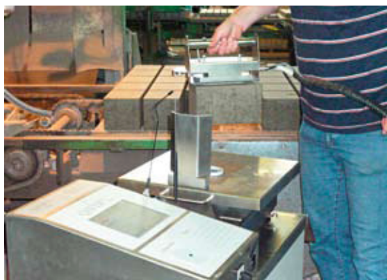
Abb. 5 Ein Frischprodukt wird aus dem laufenden Prozess für die Messung entnommen. Die gesamte Messzeit beträgt gerade mal 30-40 Sek./Stein.
